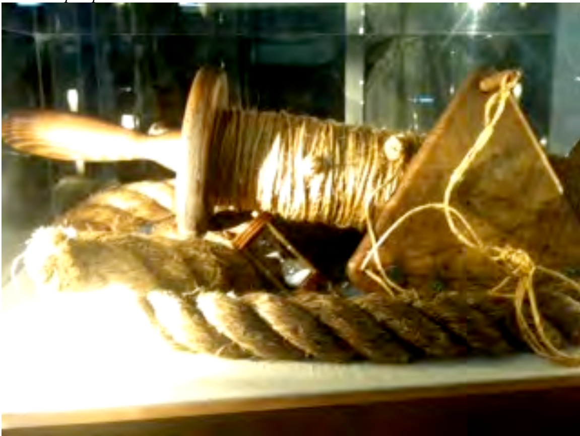
Un "loch". Remarquez les nœuds sur le filin, relié à la planchette qui le "fixe" dans l'eau Merci à AD, qui a repéré la chose et l'a immortalisée...
